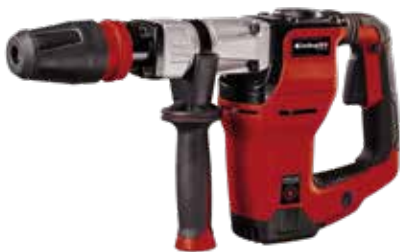
MARTILLO DEMOLEDOR-PICADOR TE-DH 12 EINHELL Potencia 1.050 W. Impactos por minuto 4.100 min -1 . Potencia de impacto 12 J. Cable de alimentación de 400 cm H07RN-F. Portabrocas SDS-Max. Baja vibración gracias a la empuñadura que absorbe las vibraciones. Incluye cincel puntiagudo y plano. Práctico estuche de transporte y almacenamiento.
