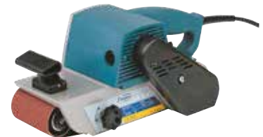
LIJADORA LBS1E VIRUTEX Dispone de unos topes internos de carburo de tungsteno para evitar el deterioro de la carcasa por desplazamiento de la banda. Potencia: 1.200 W. Dimensiones banda: 690 x 100 mm. Superficie de lijado: 175 x 100 mm. Velocidad banda: 420 m / min. Peso: 6,5 kg.
