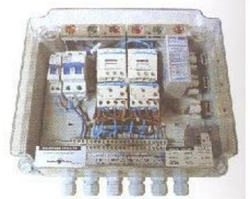
Cuadros eléctrico, simple o doble, para equipos de presión, o bombas aguas fecales, con contactor con relé térmico, magnetotérmico, interruptor M-o-A, relé de alternancia (dobles), pilotos tensión marcha y disparo térmico. (Fecales piloto alarma). Bajo demanda se pueden suministrar con reloj programador.
