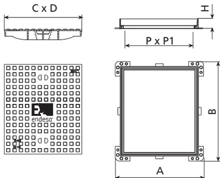
Realizadas en fundición dúctil. Cumplen con las prescripciones de la norma EN-124.
