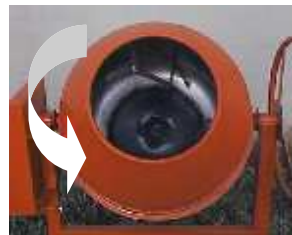
Fig. 4 – Sentido de rotación del tambor, anti-horario
