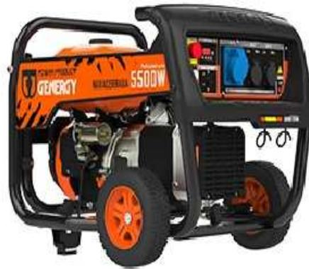
Generador con motor gasolina 4T de 5.500 W de potencia. Parada automática por falta de aceite. Alternador bobinado íntegramente cobre. Regulación electrónica del voltaje. Protección por sobrecarga mediante disyuntor térmico.
