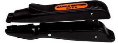
Pelacables automático para todo tipo de conductores flexibles de 0,5 a 6 mm<sup>2</sup> de sección
