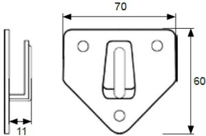
PLACA CON COLGADOR PARA EXTINTOR EN ACERO DE 60X56 MM. DISTANCIA DEL GANCHO A LA PLACA DE 6,8 MM. TIPO POLVO 1. SOPORTA UNA CARGA MAXIMA DE 6 KGS. ACABADO ZINCADO.
