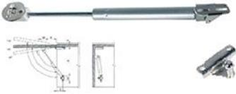
PISTON DE GAS ELEVABLE FRICCIONADO EN ALUMINIO CON POTENCIA DE 12 KGS/117 NW. POSEE SISTEMA DE FRICCION QUE MANTIENE LA PUERTA EN LAS DIFERENTES POSICIONES. MEDIDA DEL PISTON CERRADO DE 155 MM. MEDIDA DEL PISTON ABIERTO DE 255X35X16 MM. ACABADO ALUMINIO.
