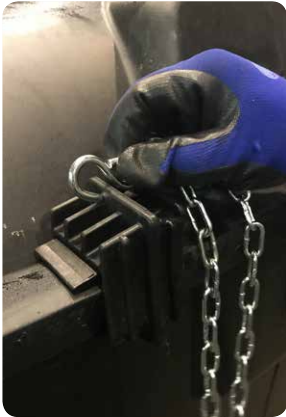
Coloque los ganchos y las cadenas en el clip
