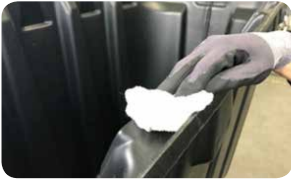
Limpie el borde del depósito con un trapo seco y desengráselo si es necesario
