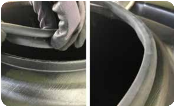
Coloque en su lugar la junta de la boca para inspección
