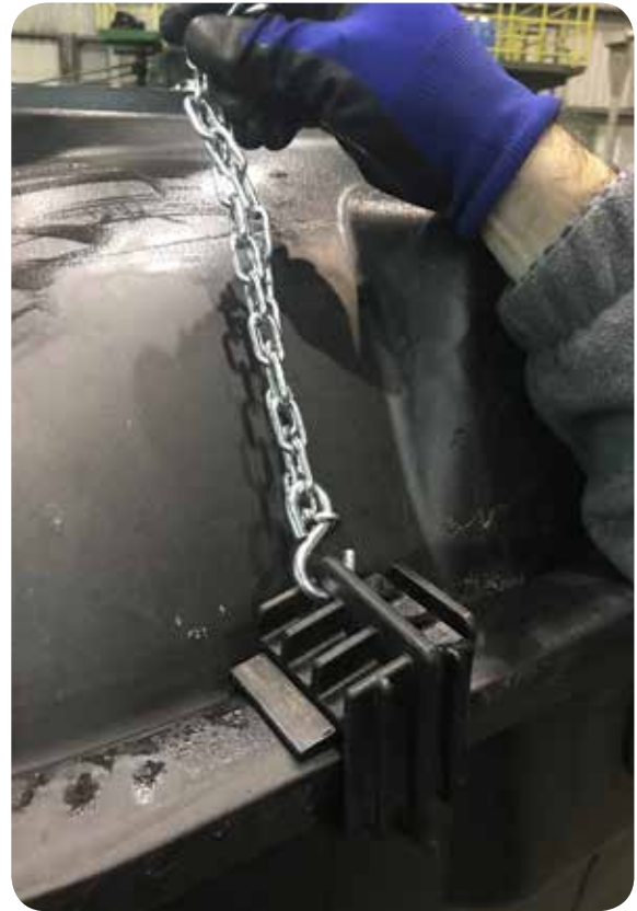
Respete los cuatro lugares de sujeción en ambos lados del tanque
