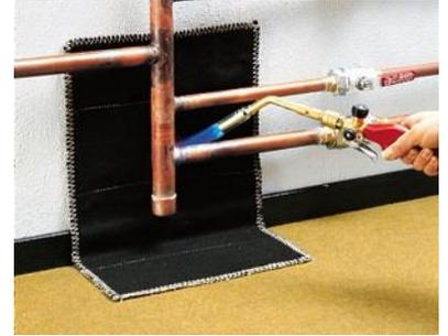
La alfombra ignífuga ROTHENBERGER protege de manera fiable los componentes, paredes y superficies de quemaduras durante el trabajo de soldadura. El material es resistente a las temperaturas permanentes hasta 700 °C y ofrece una larga vida útil incluso bajo contacto de llama directa. Trabajar se vuelve más seguro y sin perjudicar el medio ambiente.
