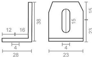
ANGULO DE FIJACION EN ACERO DE 38X28X23 MM Y ESPESOR DE 1 MM. ACABADO ZINCADO.
