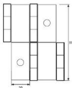
**BISAGRA PARA BIOMBO DE 50X20 MM EN ACERO. ESPESOR DE 0,9 MM. ACABADO LATONADO\***
