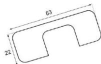
TAPA EMBELLECEDOR PARA BISAGRA DE CAZOLETA EN ACERO. MEDIDA 63X22 MM. ACABADO ZINCADO\*.
