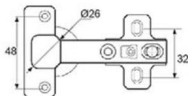
BISAGRA DE CAZOLETA EN ACERO DE 26 MM. PRESENTACION EN BOLSA DE 2 UNIDADES. INCLUYE BASE. ACABADO ZINCADO. ACODADA 85 x 52 x 20 mm S/ACODADA 85 x 52 x 31,6 mm RECTA 85 x 52 x 18,3 mm
