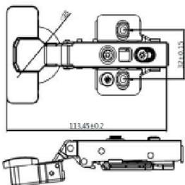
BISAGRA DE CAZOLETA DE 35 MM EN ACERO CON PISTON Y TETON. SISTEMA SOFT-CLOSE QUE PERMITE UN CIERRE AMORTIGUADO Y SILENCIOSO. INCLUYE BASE DE TRIPLE REGULACION Y TAPA EMBELLECEDORA. MEDIDA DEL TETON CAZOLETA DIAMETRO DE 10 MM Y LONGITUD DE 10,5 MM. MEDIDA DEL TETON BASE DIAMETRO DE 5 MM Y LONGITUD DE 5 MM. PRESENTACION EN BOLSA DE 2 UNIDADES. ACABADO ZINCADO.
