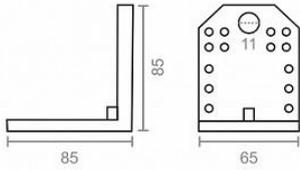
**ÁNGULO PESANTE EN ACERO DE 85X85X65 MM. ESPESOR DE 2,5 MM. ACABADO ZINCADO.**
