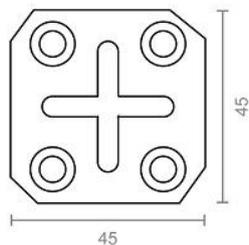
PLACA CUADRADA EN ACERO DE 45X45 MM. ESPESOR DE 1 MM. ACABADO ZINCADO.
