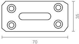
PLACA RECTANGULAR EN ACERO DE 70X35 MM. ESPESOR DE 1 MM. ACABADO ZINCADO.
