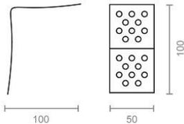
**SOPORTE PARA POSTE REDONDO EN ACERO DE 80-100 MM. ESPESOR DE 2,5 MM. ACABADO ZINCADO.**
