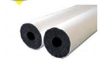
un aislamiento térmico flexible de espuma elastomérica de caucho sintético NBR, con un recubrimiento que aporta protección mecánica. Con un recubrimiento de color blanco, sus materiales permiten una alta flexibilidad y con un amplio rango de temperatura de trabajo, siendo 110 °C como máxima temperatura y de -50 °C como mínima. Gran resistencia a la radiación UV, así como un gran rendimiento con la difusión de vapor de agua. 35 mm de diámetro, 10 mm de espesor de asilamiento, 2m de longitud.
