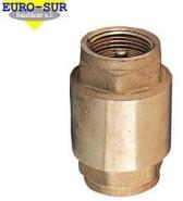
VÁLVULA DE RETENCIÓN "EUROPA" PN 25. CONSTRUCCION EN LATON UNE-EN 12165. CIERRE EN NBR (GOMA) 65 SH. MUELLE EN ACERO INOX. 18/8. EXTREMOS ROSCA GAS H-H, ISO 228/1. TEMP. MAX. 90°C. MONTAJE EN CUALQUIER POSICION.
