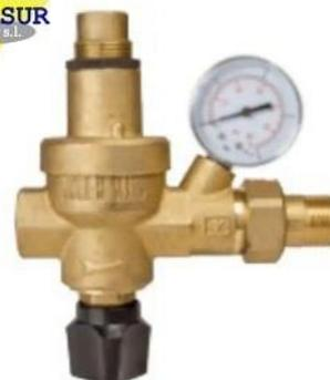
Válvula de llenado automático para usaren instalaciones de circuito cerrado a fin de conseguir una alimentación automática y constante. Esta válvula permite cortar el agua así como medir la presión del circuito. También realiza las funciones de reducción de presión y retención.
